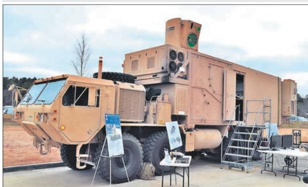
*Комплекс лазерного оружия HEL-MD на базе грузовика MSVS SMP*
