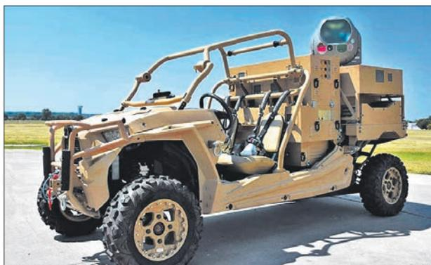
*Комплекс лазерного оружия HEL-VS на базе легкого внедорожника «Поларис» MRZR*
