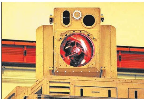
Адаптивная оптическая система лазерного комплекса «Хел-МД», смонтированная на турели боевой машины
