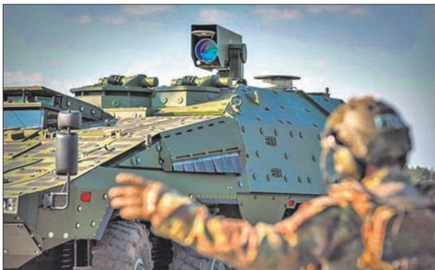
*Комплекс лазерного оружия компании «Рейнметалл», размещенный на БТР «Боксер»*
