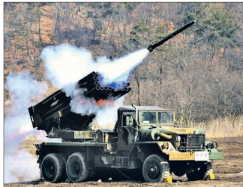
масса пусковой установки с 36 направляющими для запуска 130-мм реактивных снарядов 16,4 т. Установки снаряжаются боеприпасом, содержащим 16 тыс. стальных шариков. Дальность поражения целей от 22 до 30 км.
