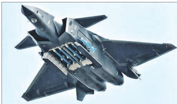
*Управляемые ракеты PL-15 (в отсеке вооружения) и PL-10 (снаружи) в предстартовом положении на истребителе «Цзянь-20»*
