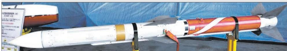
максимальная дальность стрельбы до 30 км, длина 3,1 м, диаметр 0,13 м, размах крыла 0,31 м, рулей – 0,41 м). Она имеет конструкцию, близкую к УР «Ирис-Т» и PL-10. Ее носителями являются самолеты F-15J и F-2A, B.
