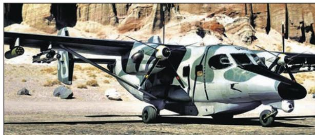
ПОЛЬСКАЯ КОМПАНИЯ «PZL МЕЛЕЦ» И АМЕРИКАНСКАЯ ФИРМА «СЬЕРРА НЕВАДА» представили в октябре 2021 года опытный образец нового многоцелевого самолета для сил специальных операций (ССО) MC-145B «Уайли Койот», выполненный на базе польского легкого транспортного M28 «Скайтрак». Переоборудование машины в конфигурацию для ССО потребовало усиления конструкции крыла и установок пилонов, способных нести до 454 кг боеприпасов. В состав вооружения MC-145B войдут
