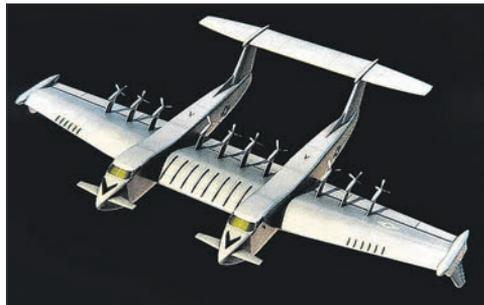
позволит создать тяжелый военно-транспортный гидросамолет со двоянным фюзеляжем для доставки тяжелых грузов с моря. По данным издания «Нейвал ньюс», он должен совершать полеты на высоте свыше 3 тыс. м и перевозить более 100 т грузов.
