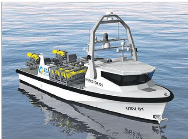
*Безэкипажный катер «Инспектор 125» с противоминными АНПА А18-М и ДУПА «К-стер С»*
