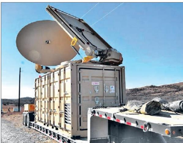
*СВЧ-комплекс противодействия БПЛА PHASER*
