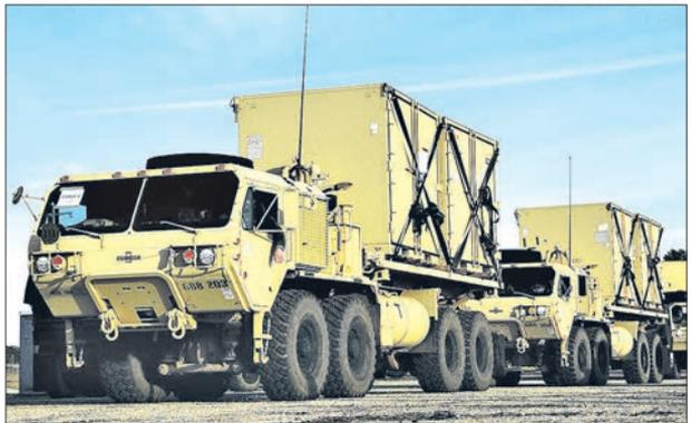
*На вооружении подразделений транспортных бригад состоят многофункциональные тяжелые тактические автомобили повышенной проходимости серии М1120 компании «Ошконт» (грузоподъемность 8–10 т в зависимости от модификации)*
