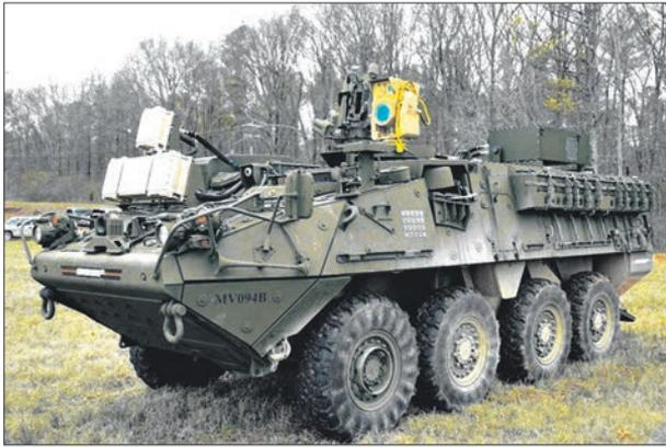
*Экспериментальный образец КЛО «Мехел»*
