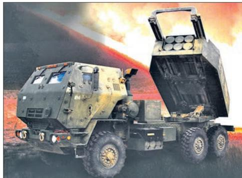
базе 5-т колесного шасси, может нести шесть реактивных снарядов или одну оперативно-тактическую баллистическую ракету. Ее максимальная дальность стрельбы 300 км.
