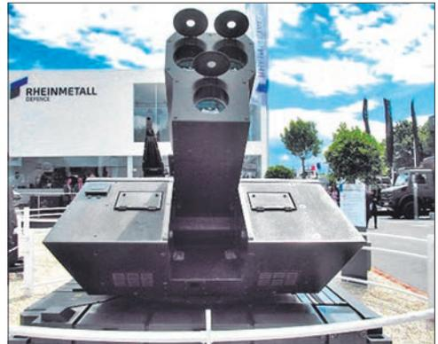
**Вариант КЛО наземного базирования компании «Рейнметалл»**
