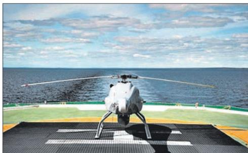
*БПЛА противоминной разведки и ретрансляции сигналов управления «Скелдар»*
