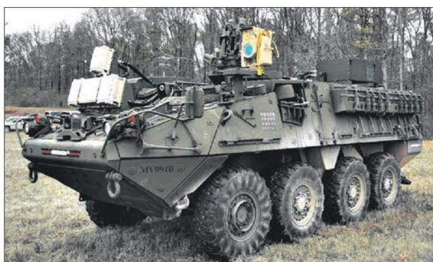
*Комплекс лазерного оружия М-МХЕЛ на базе БМ «Страйкер»*
