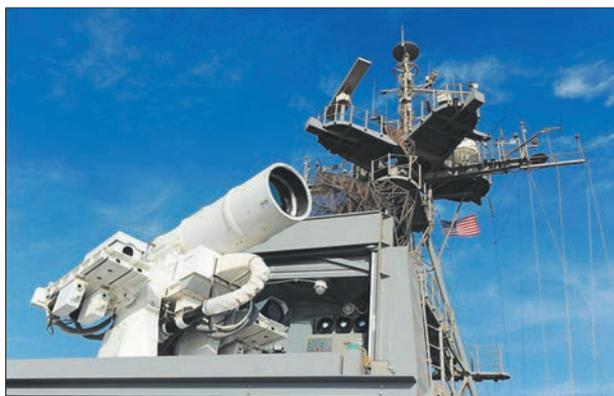
*Экспериментальный корабельный комплекс лазерного оружия «Лавс» на борту ДТД «Понсе»*
