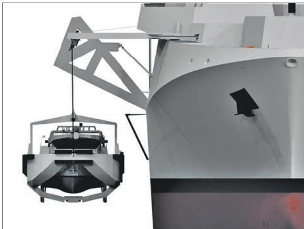
*Устройство спуска на воду и приема безэкипажного катера «Инспектор 125»*
