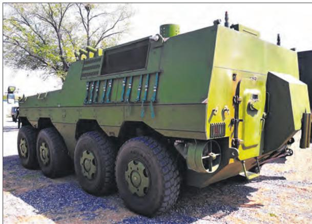
*Машина РХ-разведки НОАК на базе колесного бронетранспортера ZBL-09 с дизельным двигателем мощностью 440 л. с.*
