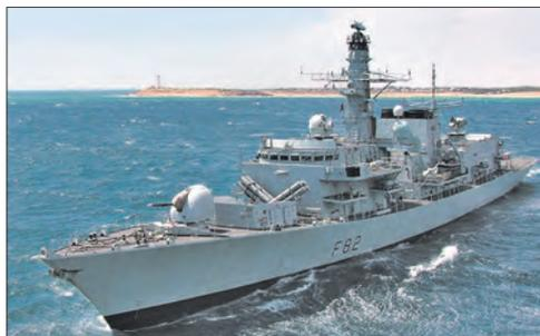
работ ФР получил улучшенный корпус и жилые помещения, усовершенствованные датчики, комплексы связи, навигации и компьютерные системы. Устаревший зенитный ракетный комплекс «Си Вулф» был заменен на современный «Си Цептор» с дальностью стрельбы до 40 км. На вооружении британских ВМС остаются 12 фрегат-тов этого типа.
