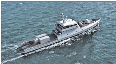
патрульных кораблей «Вало». В составе флота этого африканского государства он станет первым кораблем, оснащенным противокорабельными и зенитными управляемыми ракетами. Длина «Вало» 62 м, максимальная скорость хода 21 уз, дальность плавания 4 500 миль, экипаж 24 человека, возможно дополнительно разместить еще 24 морских пехотинца. Строительство третьего корабля должно завершиться в 2024 году.
