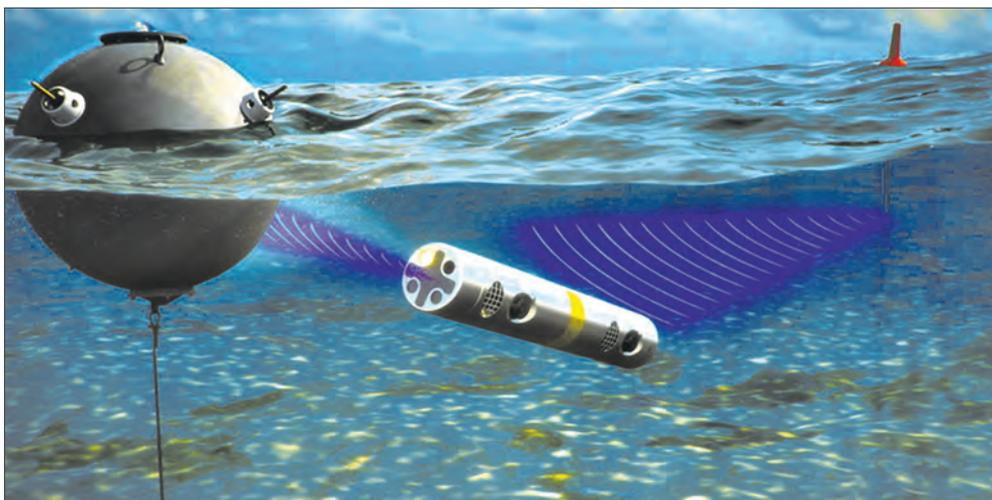
*Работа приемопередатчика акустического диапазона при выведении ПА «Барракуда» к цели и допоиск ее бортовым активным трехкоординатным гидроакустическим датчиком*
