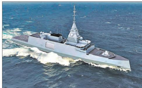
с опционом на четвертый. Длина ФР 121,6 м, ширина 17,7 м, максимальная скорость до 27 уз, дальность плавания 5 000 миль, экипаж 125 человек. На борту смогут размещаться 10-тонный вертолет и БПЛА массой до 700 кг. Закладка первого корабля должна состояться осенью 2022 года, его ходовые испытания намечены на конец лета
