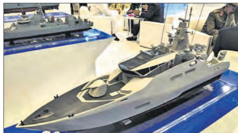
ширину 9,2 м, водоизмещение 320 т, максимальная скорость более 40 уз, дальность плавания 1 000 миль. По заявлению представителей верфи, FAS-46 планируется оснастить противокорабельными ракетами MARTE ER с дальностью стрельбы свыше 100 км и зенитным ракетным комплексом ближнего действия SIMBAD RC производства европейской компании MBDA.
