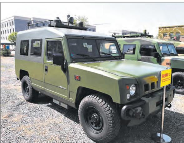
*Машина РХ-разведки на базе автомобиля «Бейджинг» VJ2022JLC*
