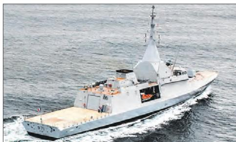
1 650 т, длина корпуса 87 м, ширина 14 м, скорость до 21 уз, дальность плавания 3 700 морских миль, экипаж 30 человек, а также до 30 человек дополнительного персонала. На борту базируется 10-тонный вертолет.
