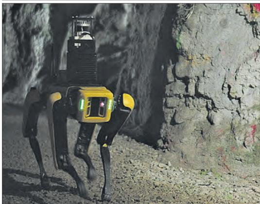
*Робототехнические комплексы, разработанные для ВС США в рамках проекта «Решение задач, связанных с обследованием туннелей и работой технических средств в условиях повышенной автономности»*
