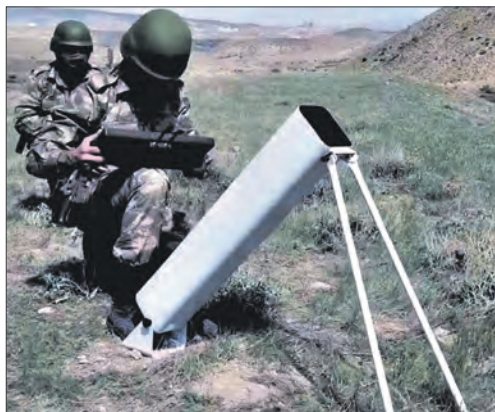
Барражирующий боеприпас «Алпагу» (справа – в транспортно-пусковом контейнере)
