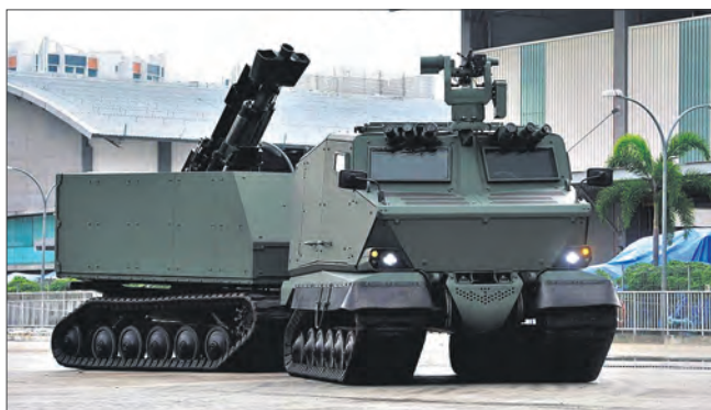
120-мм минометная система SRAMS Mk 2 (на базе гусеничного вездехода «Бронко-3»)
