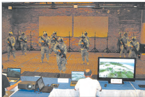
Тактический тренажерный комплекс DSTS (справа на переднем плане – автоматизированное рабочее место руководителя занятия)
