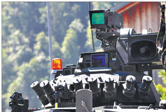
Лазерные имитаторы стрельбы из гранатомета и бронетранспортера
