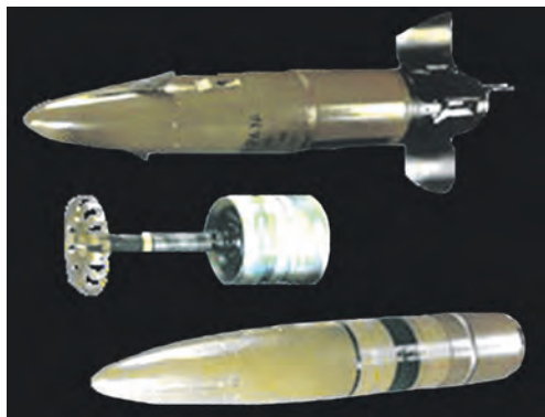
Управляемая ракета 9М119М «Инвар» для 125-мм танковых пушек
