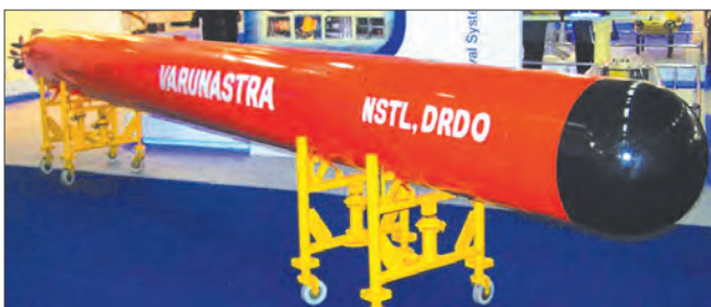
533-мм тяжелая противолодочная торпеда «Варунастра»
