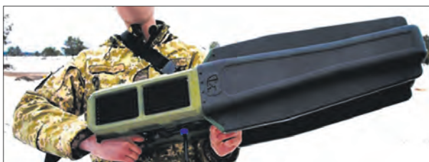
Станция РЭП «Джаммерган-3»
