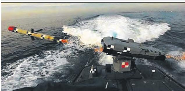
*Испытательные стрельбы управляемой ракетой «Спайк-ER» с борта БЭК «Протектор» ВМС Израиля*
