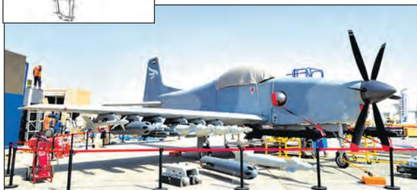
станция с инфракрасным каналом. По информации зарубежных СМИ, максимальная взлетная масса ЛШ около 9 т, размах крыла более 16 м, продолжительность полета 7 ч, дальность полета 350 км, практический потолок 10 700 м. Самолет оснащается турбовинтовым двигателем «Пратт Уитни Канада» PW127 максимальной мощностью 3 000 л. с. с шестилопастным воздушным винтом. Планер выполнен с применением композиционных материалов.
