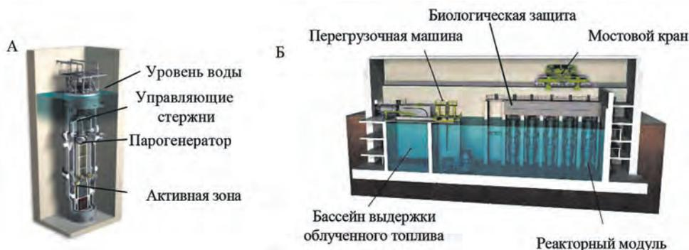
Модели реактора NuScale (А) и АЭС с шестью энергоблоками (Б)
