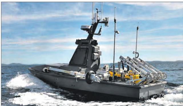
*Противоминный безэкипажный катер «Венус» с комплектом антенн средств связи и навигации*
