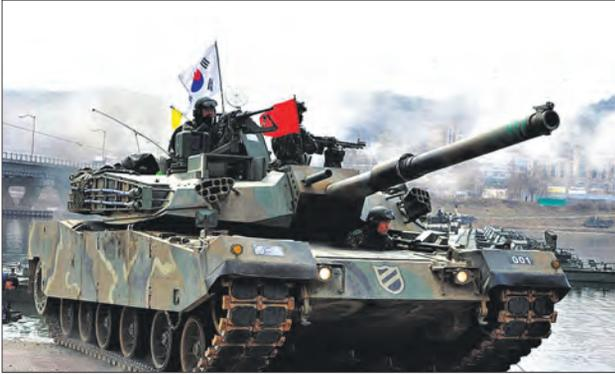
*Основной боевой танк K1 сухопутных войск Республики Корея со 105-мм пушкой*
