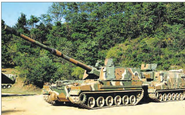
*Самоходная гаубица K9 «Тандер» с транспортно-заряжающей машиной K10, которая позволяет быстро пополнить боекомплект*
