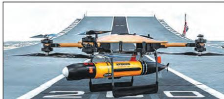
торпедой увеличит дальность поражения подводных целей. Кроме ведения борьбы с подлодками противника дистанционно управляемый аппарат планируется задействовать для решения следующих задач: поиск надводных и подводных целей противника, радиотехническая разведка, радиоэлектронная борьба, целеуказание, перевозка грузов. Предполагается, что T-650 войдет в состав авиакрыльев многоцелевых авианосцев «Куин Элизабет», «Принс оф Уэльс» и других боевых кораблей.
