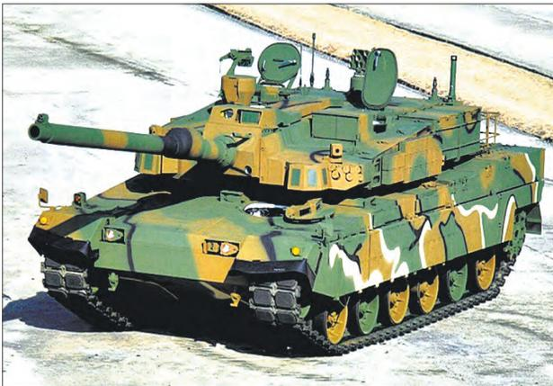
*Танк серии K2 со 120-мм гладкоствольной пушкой фирмы «Рейнметалл» (экипаж машины три человека)*
