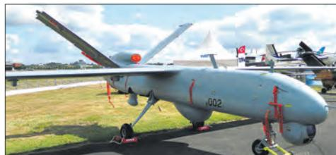
та 4 900 км, максимальная высота 9 200 м. Этот дрон применяется для сбора разведывательных данных, а при необходимости для уничтожения наземных целей. Оснащается двумя ракетами класса «воздух – земля».
