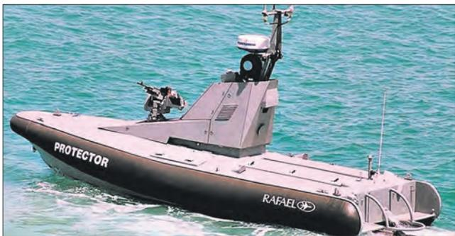
*Безэкипажный катер «Протектор» с дистанционно управляемым пулеметом*
