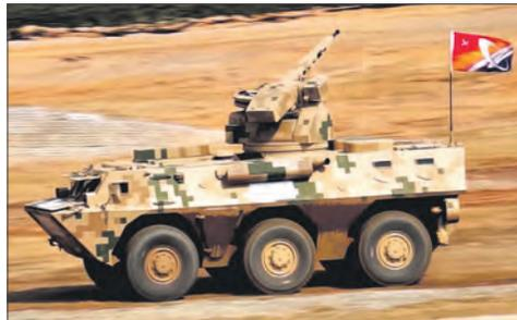
работанной китайской компанией НОРИНКО. Она оснащена одноместной башней с 12,7-мм пулеметом и 7,62-мм спаренным пулеметом с боезапасом на 500 и 1 000 выстрелов соответственно. Масса VN2C 19 т, максимальная скорость 100 км/ч.
