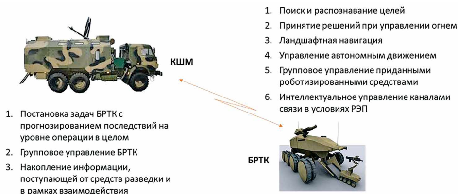
Рис. 4. Функциональные подсистемы комплекса в составе командно-штабной машины (КШМ) и боевого робототехнического комплекса (БРТК)
