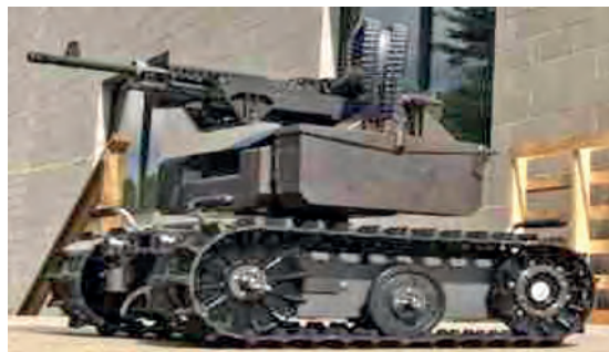
Рис. 3. Боевой робот MAARS с пулеметом M240B (США)
