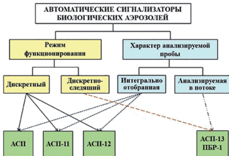
Рис. 1. Классификация автоматических сигнализаторов аэрозоля биологических средств и токсинов по режиму функционирования и характеру анализируемой пробы
