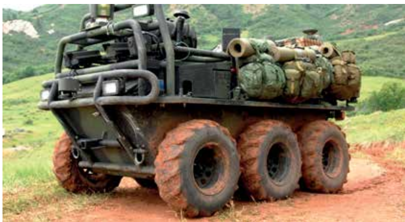
Рис. 7. РТК боевого обеспечения четвертого типа. Предназначены для подвоза боеприпасов и других материальных средств
