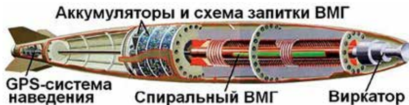
Рис. 11. Электромагнитный боеприпас с электротермической пушкой
