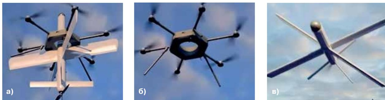
Рис. 16. Новый ударный беспилотный авиационный комплекс ST-35 «Гром» украинского производства: а — в период барражирования; б — в момент отстрела боеприпаса; в — в период атаки на цель
