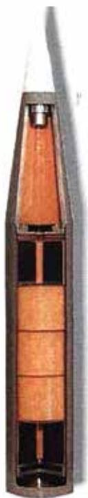
**Рис. 3. Дымокурающая головная часть 122-мм реактивного снаряда**
