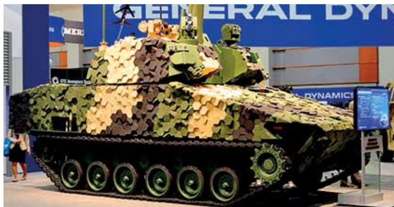
Рис. 3. Элементы многоспектрального камуфляжного покрытия на танке «Гриффин-3» (США)
