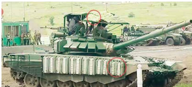
**Рис. 5. Вариант размещения на башне танка основы для защитно-маскировочного покрытия и средств снижения теплового контраста**
