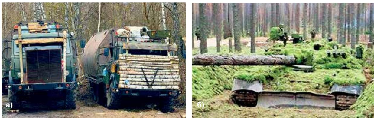
**Рис. 4. Варианты использования подручных и местных материалов для повышения защищенности (а) и снижения заметности (б) ВВСТ**
