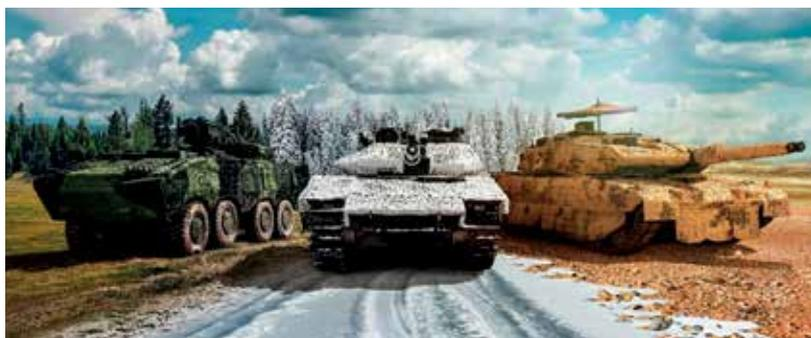
Рис. 2. Варианты размещения маскировочных систем на зарубежных боевых бронированных машинах для их скрытия в условиях лесистой (слева), заснеженной (в центре) и пустынной (справа) местности
