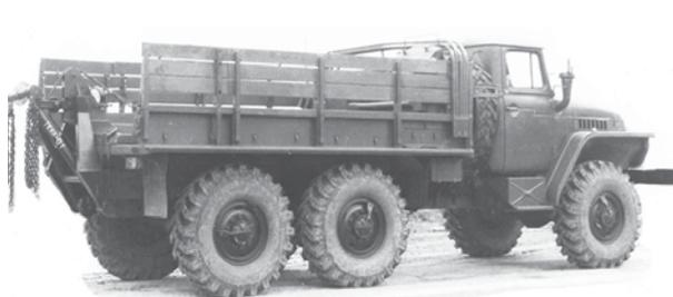
**Рис. 9. Колесный эвакуационный транспортер КТ-Л (TK 6А) на шасси Урал-375Д (1964 г.)**
