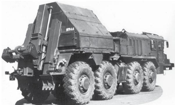
**Рис. 13. Машина технической помощи МТП-А4 на шасси КЗКТ-74281 (1996 г.)**
