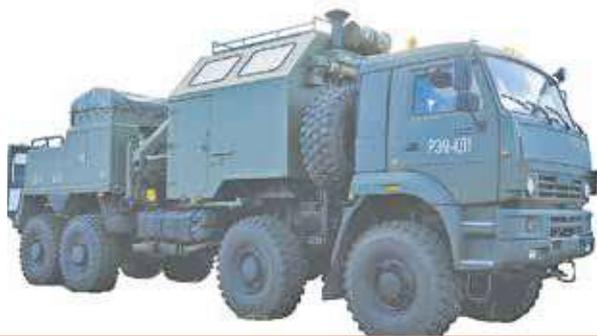
Рис. 23. Ремонтно-эвакуационная машина РЭМ-КЛ1 на шасси КАМАЗ-6560
