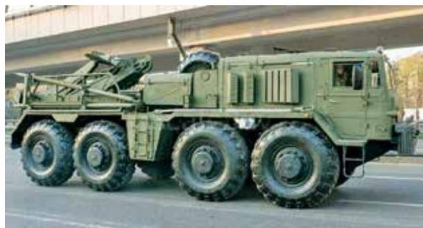
Рис. 19. Колесный эвакуационный тягач тяжелый КЭТ-Т (ТК7) на шасси МАЗ-537Г (1988 г.)
