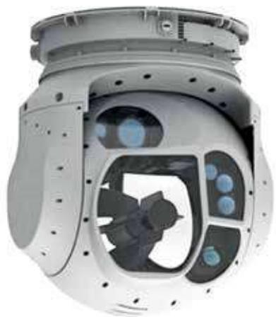
Рис. 1. Турецкая гиросtabilизированная оптико-электронная система CATS ASELISAN
