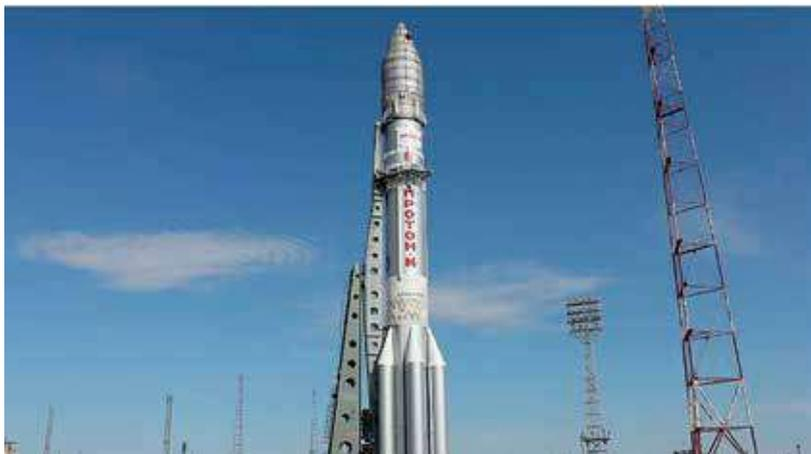
**Рис. 4. Трехступенчатый вариант РН УР-500К (8К82К «Протон-К»)**
