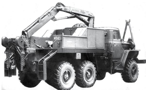
**Рис. 12. Машина технической помощи МТП-А2.1 на шасси Урал-4320 (1999 г.)**
