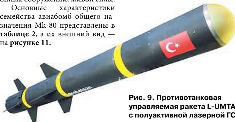
Рис. 9. Противотанковая управляемая ракета L-UMTAS с полуактивной лазерной ГСН
