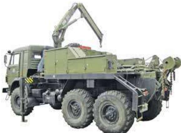
**Рис. 11. Машина технической помощи МТП-А2 на шасси КамАЗ-4310 (1993 г.)**
