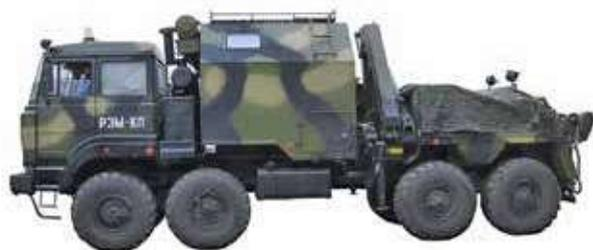
Рис. 20. Ремонтно-эвакуационная машина РЭМ-КЛ на шасси Урал-532362 (2008 г.)
