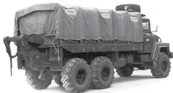
**Рис. 16. Машина технической помощи МТП-А7 на шасси КрАЗ -260 (1994 г.)**
