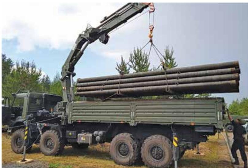
Рис. 9. Погрузка труб на автомобиль-трубовоз КМВ-20К
