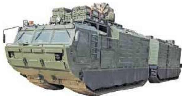
Рис. 24. Ремонтно-эвакуационная машина РЭМ-ГТ на ДТ-30ПМ
