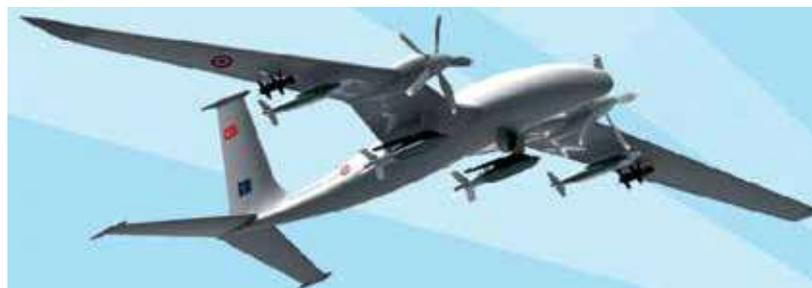
Рис. 2. БПЛА «Байрактар Акынджи» с ГОЭС CATS ASELISAN, установленной в передней нижней части фюзеляжа
