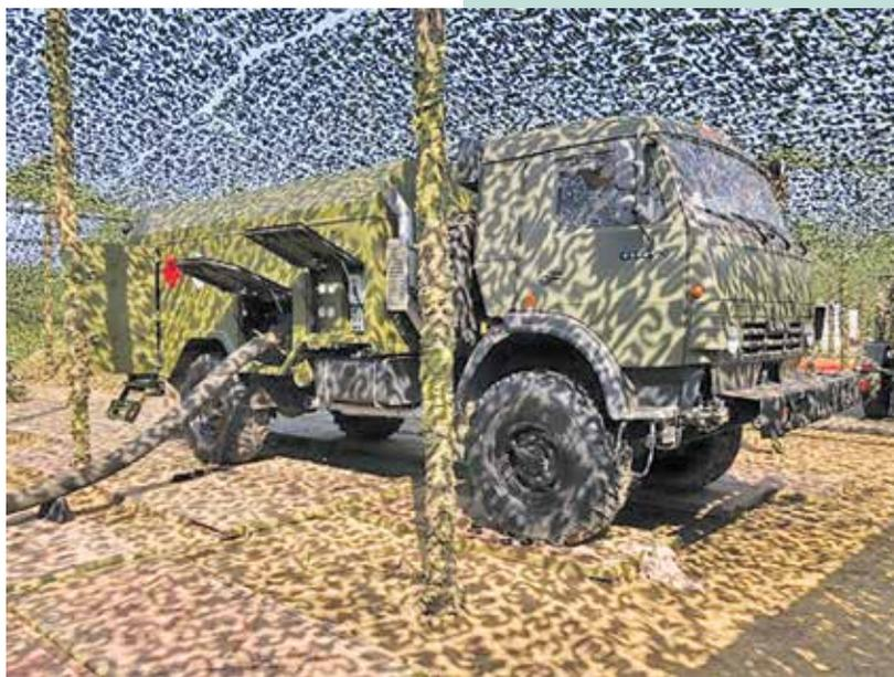
Рис. 6. Перекачивающая станция горючего ПСГ-180
