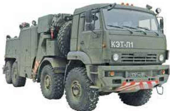
Рис. 22. Колесный эвакуационный тягач легкий КЭТ-Л1 на шасси КАМАЗ-6560
