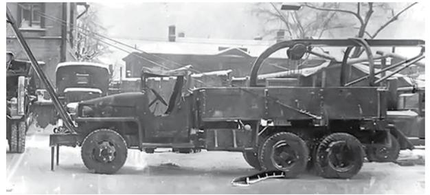
**Рис. 2. Эвакуационный тягач на базе автомобиля «Студебеккер»**
