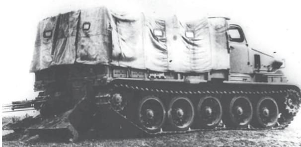
**Рис. 4. Гусеничный эвакуационный тягач ГЭТ (ТГ1) на шасси АТС-59 (1959 г.)**
