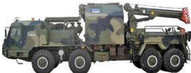
Рис. 21. Ремонтно-эвакуационная машина РЭМ-КС на шасси БАЗ-6910 (2017 г.)
