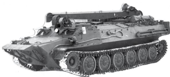
**Рис. 15. Машина технической помощи МТП-А6 на МТ-ЛБ (1989 г.)**
