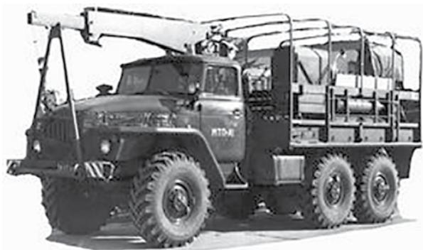
**Рис. 10. Машина технической помощи МТП-А.1.1 на шасси Урал-4320 (1989 г.)**
