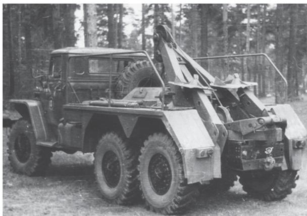
**Рис. 8. Колесный эвакуационный тягач КЭТ-Л (TK 5В) на шасси Урал-375Д (1964 г.)**
