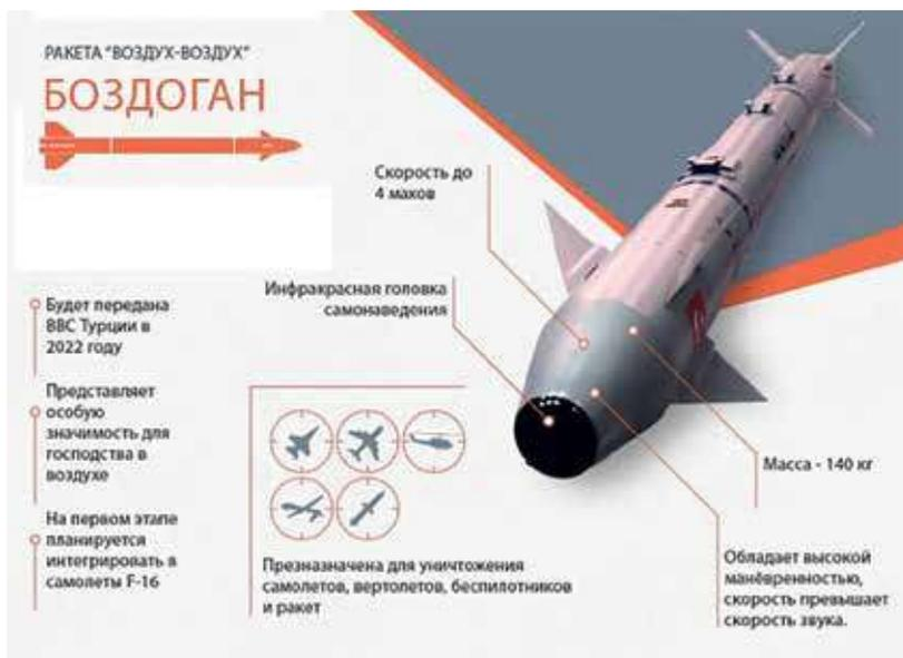
**Рис. 5. Внешний вид и основные технические характеристики турецкой ракеты *Vozdogan* «Боздоган» класса «воздух – воздух»**
