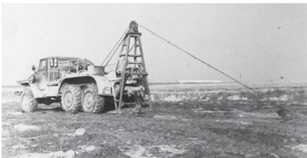
**Рис. 7. Колесный эвакуационный тягач КЭТ-Л (TK 5А) на шасси Урал-375Д (1963 г.)**
