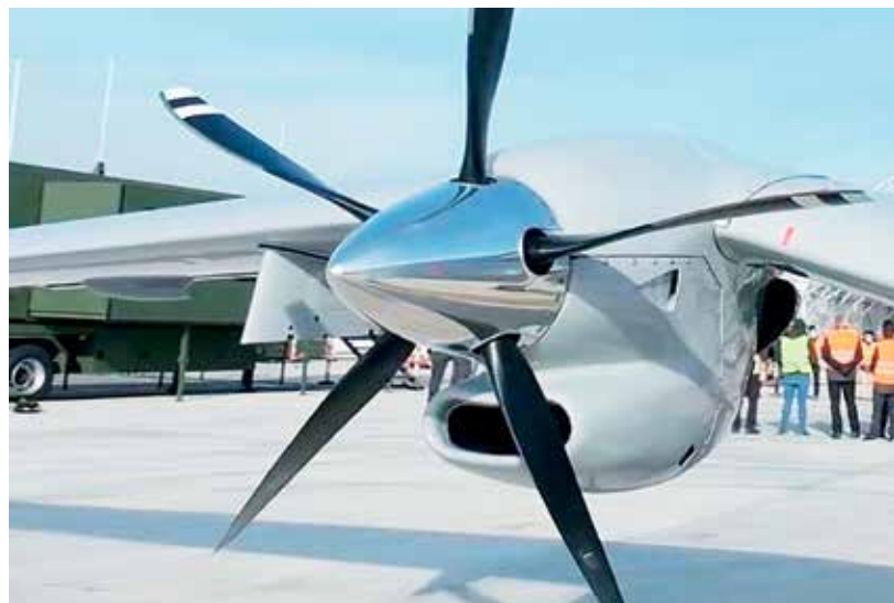
Рис. 8. Пятилопастной воздушный винт АИ-П500В5 (АИ-Р500В5) силовой установки БЛА «Байрактар Акынджи»
