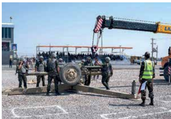
Рис. 6. Демонтаж ствола с изделия Д-30
