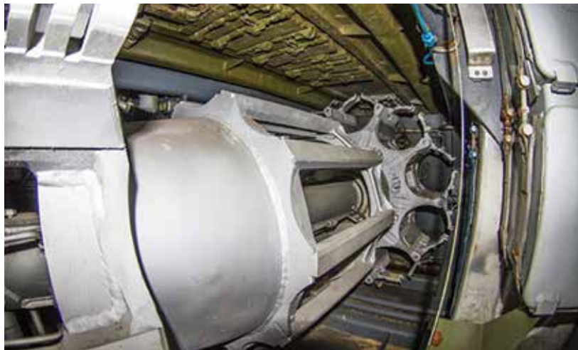
Рис. 8. Механизированная боеукладка миномета
