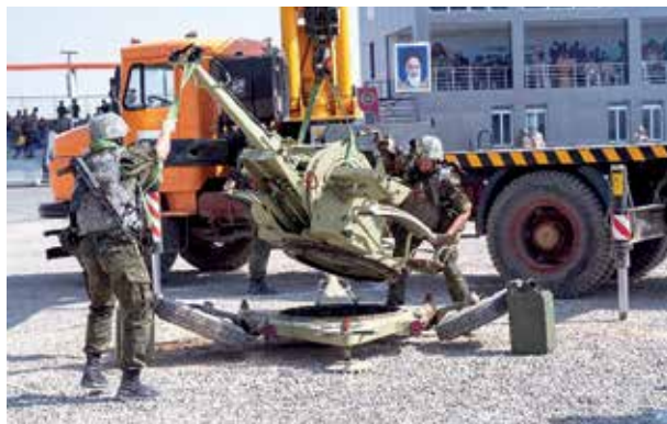
Рис. 7. Разборка зенитных автоматов и демонтаж верхнего станка с люлькой
