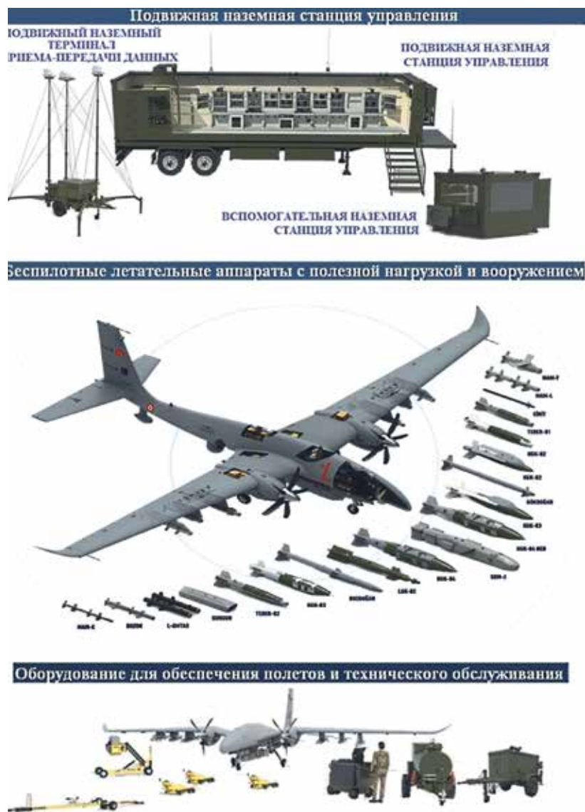
Рис. 1. Типовая структура БАК ВН «Байрактар Акынджи»
