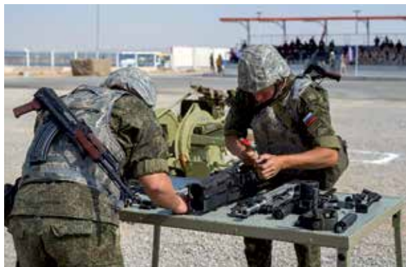
Рис. 7. Разборка зенитных автоматов и демонтаж верхнего станка с люлькой
