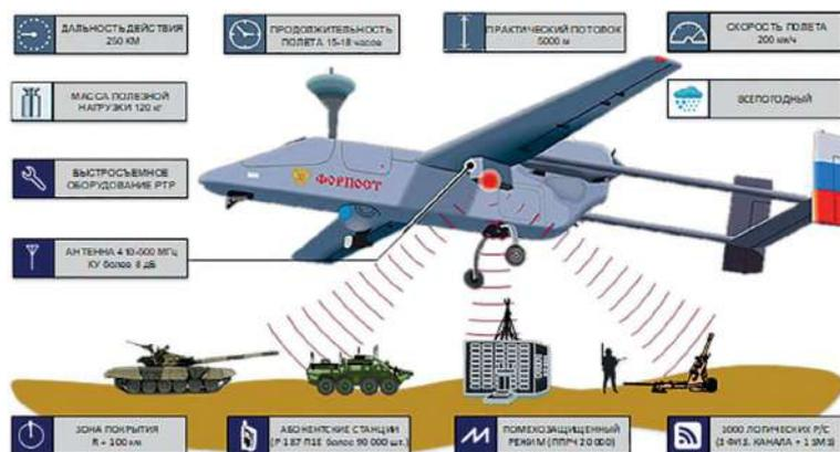
**Рис. 16.** Основные характеристики ретранслятора связи P-187-PTP на базе БпЛА «Форпост-М»
