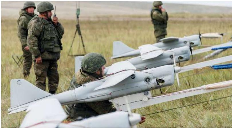
Рис. 3. БПЛА самолетного типа «Орлан-10»
