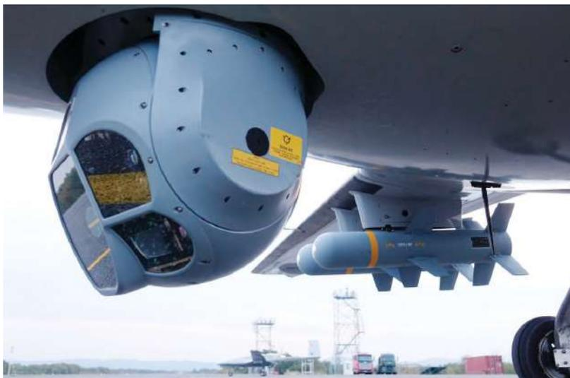
**Рис. 13. Турецкая ГОЭС CATS, установленная на БЛА «Байрактар-ТБ2»**
