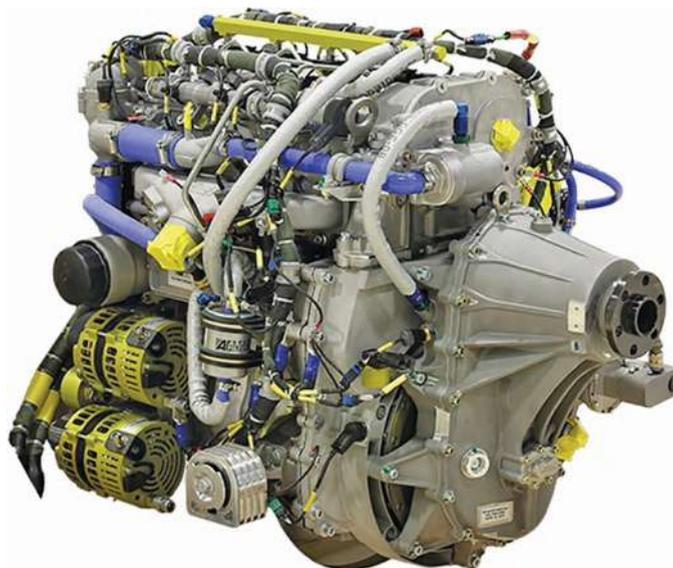
**Рис. 19.** Турецкий авиационный дизельный поршневой двигатель с турбонаддувом TEI PD-170
