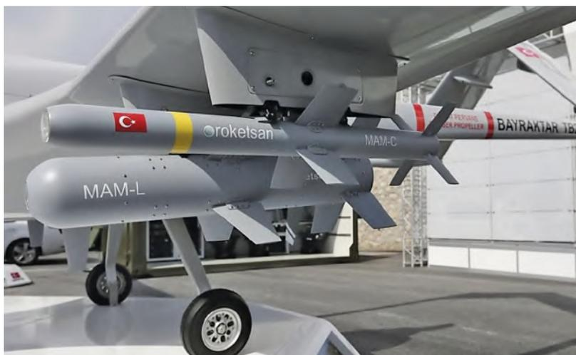
**Рис. 15.** Установка КАБ МАМ-Л и МАМ-С на внешней подвеске беспилотника «Байрактар-ТБ2» (на четырех точках под крыльями — по две под каждым крылом)
