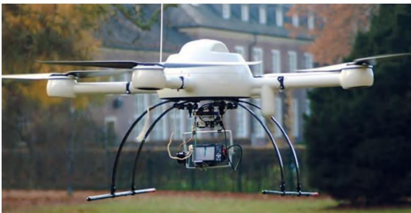
Рис. 5. БПЛА мультироторного типа «Гранад ВА-1000»
