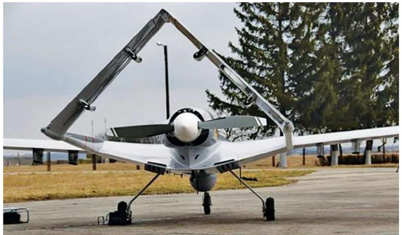
**Рис. 9. Толкающий двухлопастный винт с регулируемым шагом силовой установки БПЛА «Байрактар-ТБ2»**
