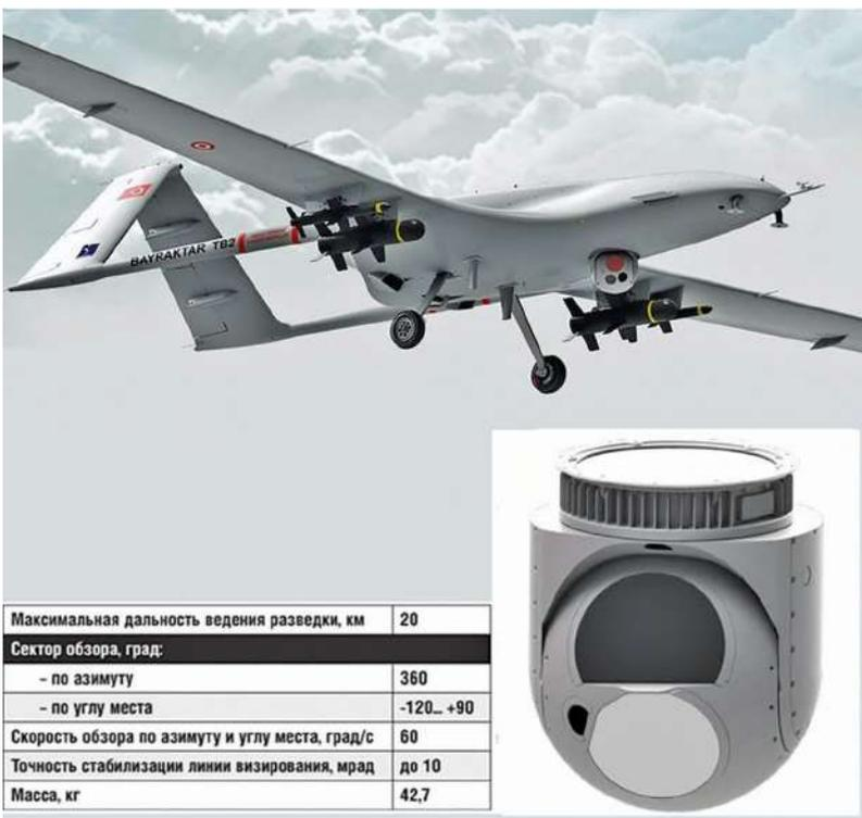
**Рис. 11.** Гиростабилизированная оптико-электронная система БПЛА «Байрактар-ТБ2»
