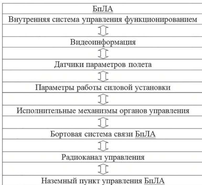
**Рис. 3. Структура пилотажного метода управления БПЛА**
