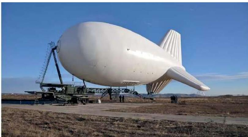
Рис. 2. Мобильный аэростатный комплекс мониторинга и ретрансляции «Вега-04»
