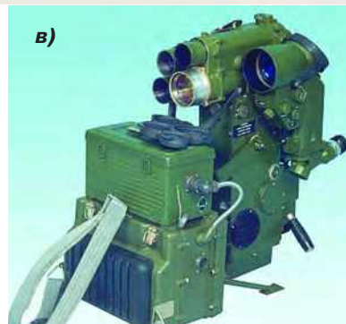
Рис. 1. Лазерное оружие — а [12]. Российский лазерный карабин — б [11]. Переносной лазерный прибор оптико-электронного противодействия ПАПВ [13], близкий аналог советского переносного лазерного комплекса 1К12 «Карьер» — в
